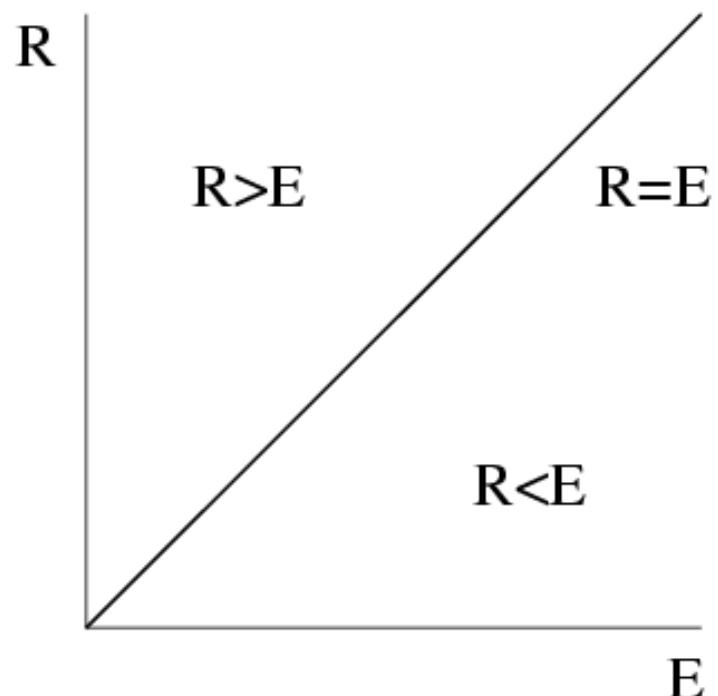
jsou-li odolnost konstrukce a účinek zatížení normálně rozdělené náhodné veličiny, definuje se rezerva spolehlivosti  $Z = R - E$
