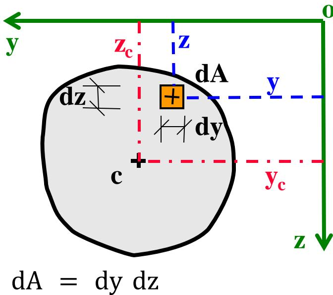
$y_c, z_c$  – souřadnice těžiště průřezu.
