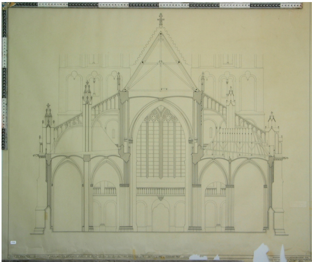
Obr. 10.4 – Xanten, dóm sv. Viktora, plán č. 17713 – příčný řez (převzato z [103])
