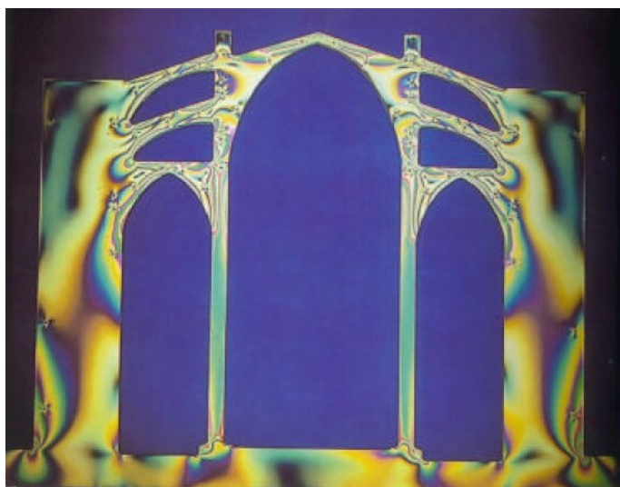
Obr. 3.1 - Fotoelastický snímek modelu katedrály na Malorce (převzato z [32])
