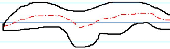
střednicový model: zjednodušení výpočtu redukcí ke střednici
