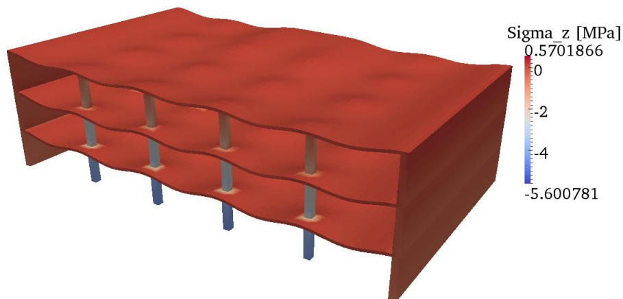
Obrázek 45: Svislé napětí \sigma_z bez zatížení poklesy pro model s kontaktními prvky bez uvažování tahu, faktor zvětšení posunů 500\times
