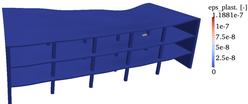
Obrázek 78: První plastické deformace \gamma_{yz} , faktor zvětšení posunů 130\times
