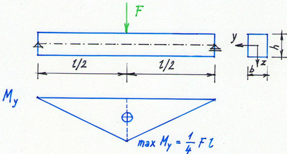
Plastické oblasti se začnou vytvářet při zatížení  $F = F_{el}$  a úplný plastický kloub vznikne při zatížení  $F = F_{pl}$ .
