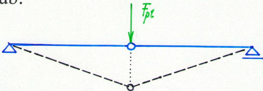
*staticky přeuročitá konstrukce - pohyblivý mechanismus*
