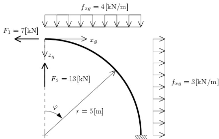
*Kontrola.* Vnitřní síly ve stejném pořadí jako jsou zadány úhly jsou  $N \in \{7; 5,822; 1,035; -3,991; -7\}$  kN,  $V \in \{13; 0,1029; -2,651; -1,727; 8\}$  kN a  $M \in \{0; 15,984; 13,923; 10,667; 17,5\}$  kNm.
