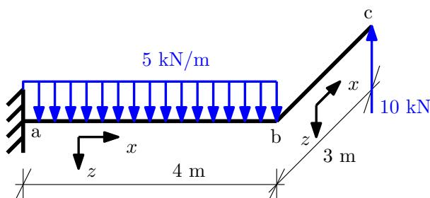
*Kontrola.*  $V_z^b = -10 \text{ kN}$ ,  $M_x^{ba} = 30 \text{ kNm}$ ,  $M_x^{bc} = 0 \text{ kNm}$ ,  $M_y^{bc} = 30 \text{ kNm}$ ,  $M_y^{ba} = 0 \text{ kNm}$ , extrém ohybového momentu  $M_y$  na intervalu  $(a; b)$  je  $M_{y,\text{ext}}^{a-b} = 10 \text{ kNm}$ .
