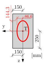
**Poznámka:** Pokud je průřez symetrický, pak je deviační moment  $D_{yz}$  nulový. Potom jsou těžišťové momenty setrvačnosti zároveň hlavními momenty setrvačnosti a osy se nepootočí o žádný úhel. Není tedy nutné počítat  $I_{1,2}$ . Zde je uvedeno pouze ilustrativně.
