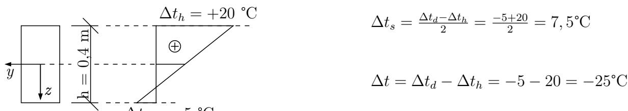
Řešení: Přemístění průřezu e musíme určit jako součet posunu  $w_e^f$  od silového zatížení a posunu  $w_e^t$  od nerovnoměrné změny teploty
