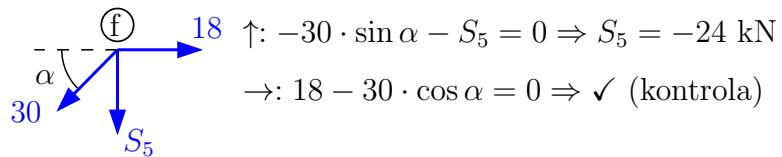
Normálové síly  $\bar{N}_i$  od virtuálního jednotkového zatížení vyřešíme stejným způsobem. Pro jednoduchost opět nejprve určíme nulové prutu a styčníkovou metodu následně využijeme pouze u nenulových prutů.
