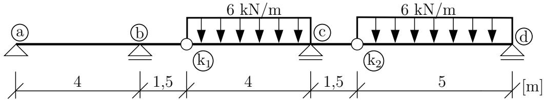
Řešení: obě přetvoření budeme počítat pouze s vlivem ohybových momentů podle vzorce:
