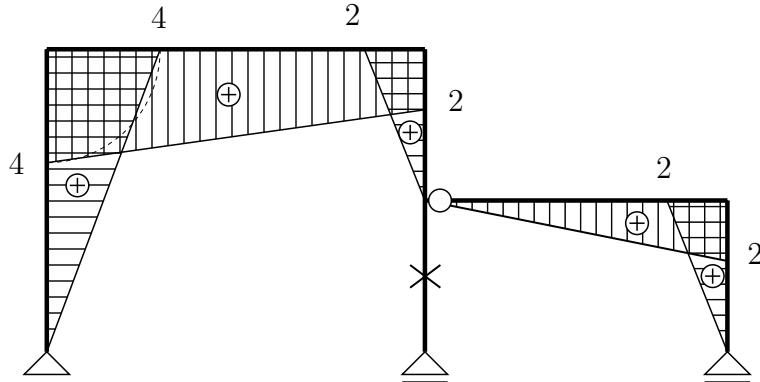
Normálové síly  $\bar{N}$  od virtuálního stavu.
