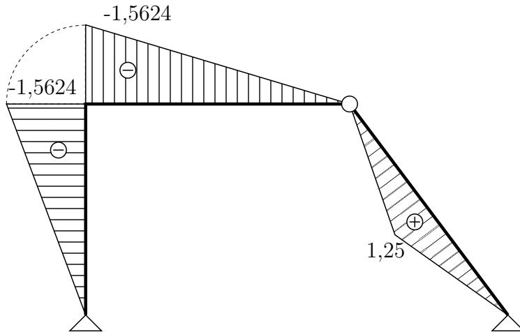
Průběh normálových sil  $\bar{N}$  od virtuálního stavu:
