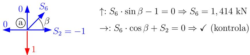
Svislý posun styčníku ④ od silového zatížení.
