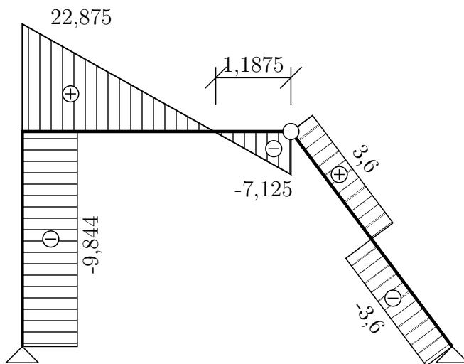
Průběh ohybových momentů  $M$  od reálného stavu:
