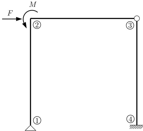
Při řešení ODM vycházíme z předpokladu, že pruty jsou stlačitelné ve směru své podélné osy a každý styčník se tak může posunout ve směru osy x, ve směru osy z a natočit kolem osy y – pokud některé z těchto deformací nezabráníme podporou přímo v řešeném styčníku.
