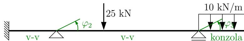
2. provedeme redukci převislého konce k bodu 3, a tím zjednodušíme konstrukci na nosník o dvou polích s jednou neznámou  $\varphi_2$ . Tato varianta řešení je početně méně náročná, proto v ní budeme dále pokračovat.
