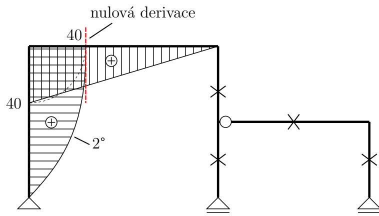
Výpočet pootočení  $\varphi_a$ : konstrukci zatížíme jednotkovým momentem v bodě ① a vypočteme reakce a vnitřní síly.
