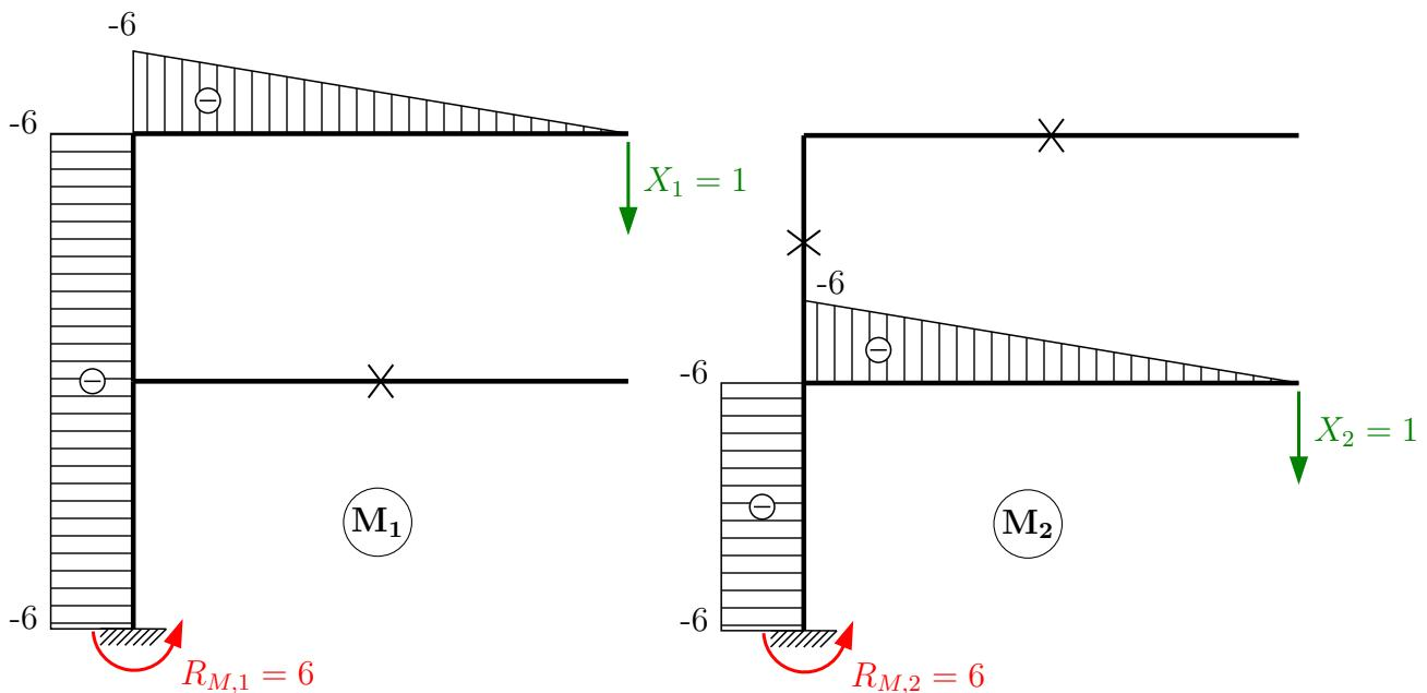
Reakce  $R_{M,1}$  a  $R_{M,2}$  zavádíme povinně po směru pootočení  $\tilde{\varphi}_a$ .
