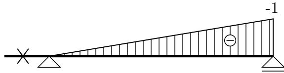
Funkce ohybových momentů  $M_y(x)$  a  $\bar{M}_y(x)$  dosadíme do vzorce pro výpočet přemístění, místo  $\delta$  píšeme  $\varphi_b$  a budeme integrovat po jednotlivých intervalech  $\overline{ca}$  a  $\overline{ab}$ :
