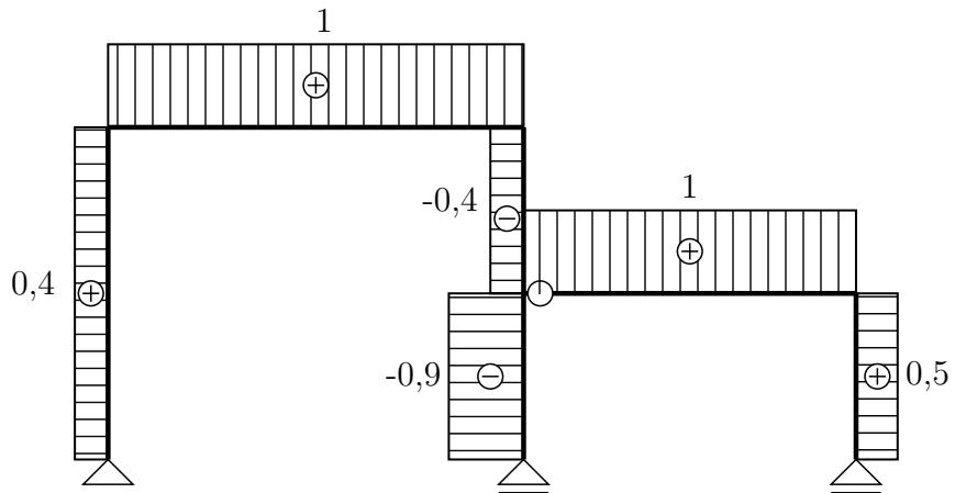
Pozn.: stejně jako při výpočtu pootočení  $\varphi_a$  i zde by stačilo určit průběh  $\bar{N}$  na desce vpravo. Opět je pro úplnost vykreslen průběh po celé konstrukci.
