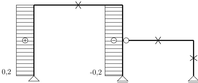
Výpočet můžeme rozdělit na tři části, a sice určení pootočení od silového zatížení  $\varphi_a^f$ , od změny teploty  $\varphi_a^t$  a od poklesu podpory  $\varphi_a^r$ .
