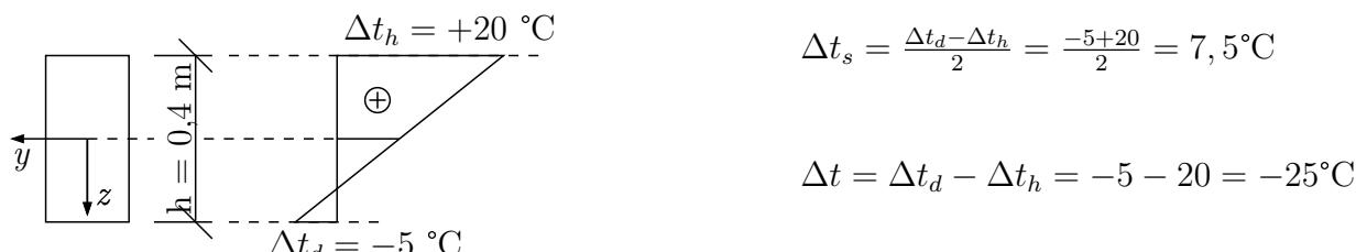
Řešení: Přemístění průřezu (e) musíme určit jako součet posunu  $w_e^f$  od silového zatížení a posunu  $w_e^t$  od nerovnoměrné změny teploty.
