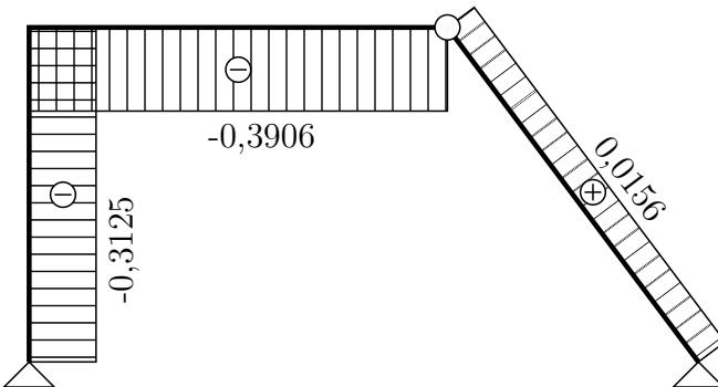
Průhyb  $w_e^f$  od silového zatížení:
