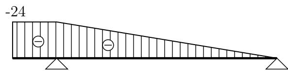
Vytvoříme virtuální stav. Do průřezu (b), ve kterém hledáme pootočení, zavedeme jednotkový virtuální moment. Zapíšeme funkce  $\bar{M}_y(x)$ :
