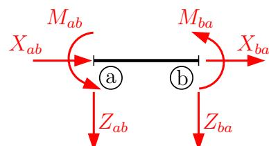
Kladné směry koncových sil na styčník jsou zavedeny na opačnou stranu než koncové sily zaváděné na prut!
