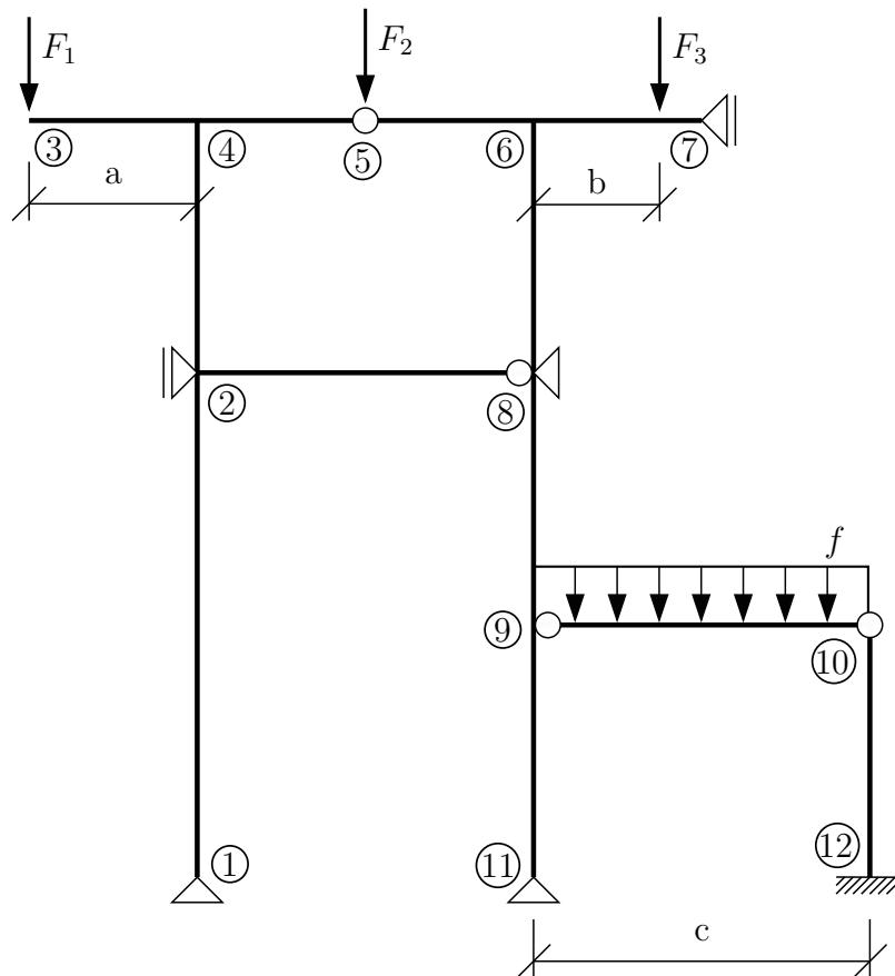
a) Řešení ODM se statickou kondenzací – pruty uvažujeme typu v-v, v-k, k-v a k-k:
