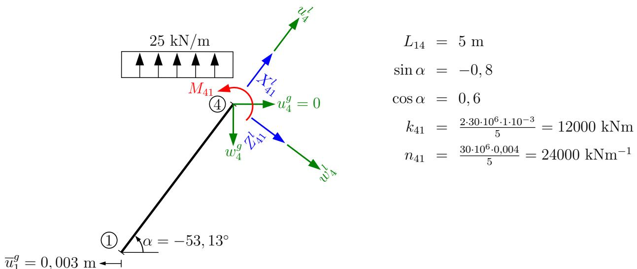
Zatížení je nutné přepočítat na délku prutu a rozložit do složky kolmé na prut a ve směru prutu:
