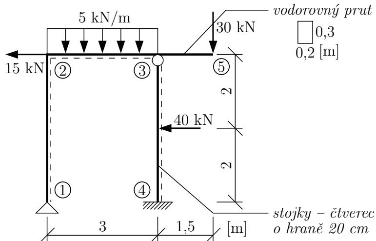
Řešení: Na konstrukci určíme deformační neznámé a typy prutů. Uvažujeme nejmenší možný počet neznámých (redukce konzoly + statická kondenzace). Čárkovou čarou jsou označena spodní vlákna.
