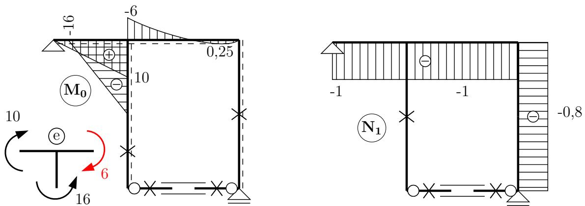
Kyvný prut přenáší pouze  $X_2 = 1$ , v ostatních zatežovacích stavech je v něm  $N = 0$  kN.
