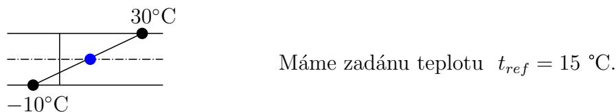
1. Teplota ve střednici pro těžiště průřezu uprostřed výšky h:
