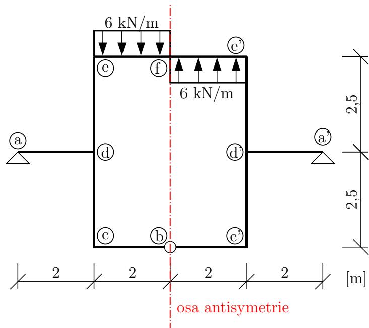
Určíme stupeň statické určitosti konstrukce (bez využití symetrie nebo antisymetrie):
