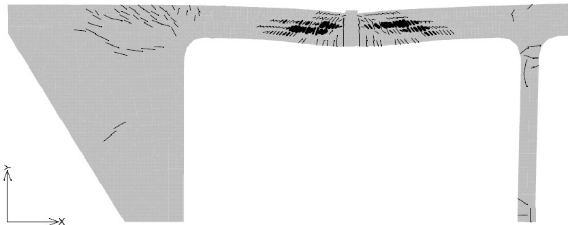
obr. 3.16: Detail modelu trhlin na vrcholu zatížení, trhliny větší než > 1 mm, krok 37
