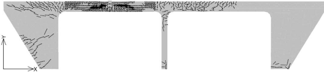
obr. 3.15: Model trhlin na vrcholu zatížení, trhliny větší než > 0,1 mm, krok 37
