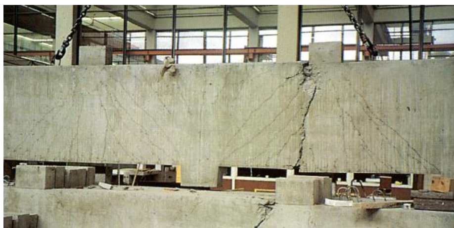
obr. 4.9: Stěna namáhaná na smyk, testovaná v laboratoři, Asin (1999)
