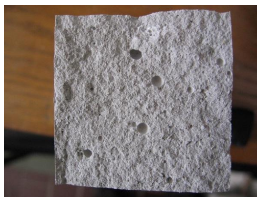
Obrázek 3 (vlevo) – Řez tělesem z fáze 1 – viditelné hrudky vápna
