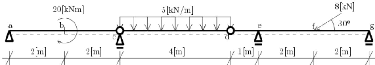
Kontrola.  $N^b = -6,928 \text{ kN}$ ,  $V^b = -5 \text{ kN}$ ,  $V^d = -10 \text{ kN}$ ,  $M^{ba} = -10 \text{ kNm}$ ,  $M^e = -10 \text{ kNm}$ ,  $M^f = -1 \text{ kNm}$  a maximální moment na intervalu c-d má velikost 10 kNm.
