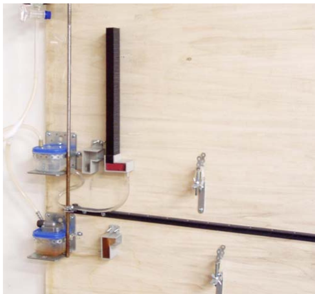
Obr. 2: Schéma experimentu pro stanovení součinitele vlhkostní vodivosti
