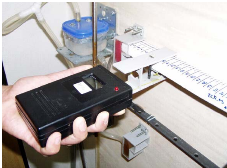
Obr. 23: Schéma experimentu pro měření součinitele vlhkostní vodivosti
