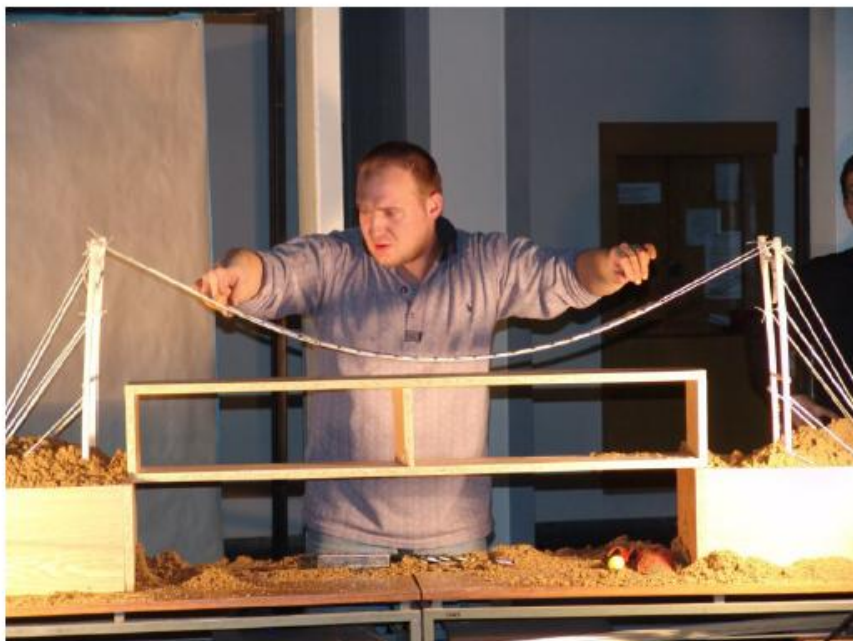
Zatížení konstrukce tíhou destiček Fakulta stavební ČVUT v Praze, 2005 departments.fsv.cvut.cz/halaroku
