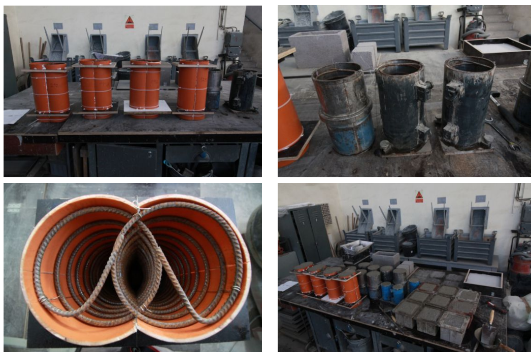
Obrázek 34: Betonáž a ukázka bednění. Pro sloup se dvěma spirálami bylo vyrobeno bednění z KG trubek. Pro válce se použila standardní forma. Spirály byly natočené a samy o sobě si zachovávaly svůj tvar.
