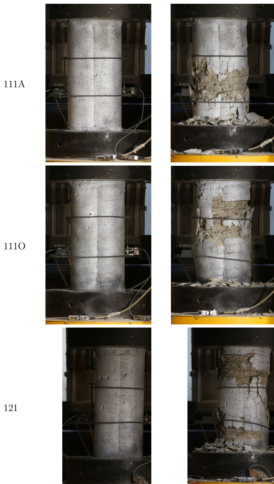
Obrázek 38: Výchozí stav zkušebního tělesa a stav po ukončení zkoušky.
