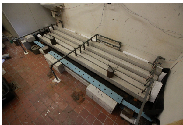
Obrázek 8: Zatížení zkušebního nosníku B5 dvěma závažími o hmotnosti 15 kg.
