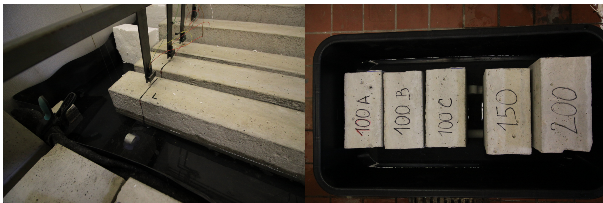
Obrázek 9: Zkušební nosníky a přidružené kvádry ponořené do vody.
