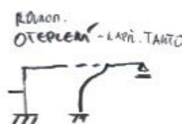
$$\begin{bmatrix} 16666 & 3333 & 3750 \\ 3333 & 24166 & 3750 \\ 3750 & 3750 & 3750 \end{bmatrix} \begin{pmatrix} \varphi_b \\ \varphi_c \\ w \end{pmatrix} = \begin{pmatrix} -11 \\ 2,5625 \\ -1,21875 \end{pmatrix}$$
