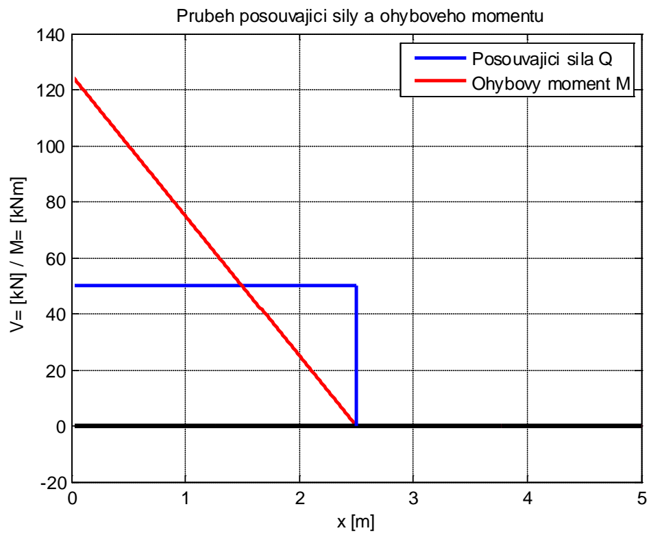
Obr. 5 Průběh posouvající síly a ohybového momentu na konzole
