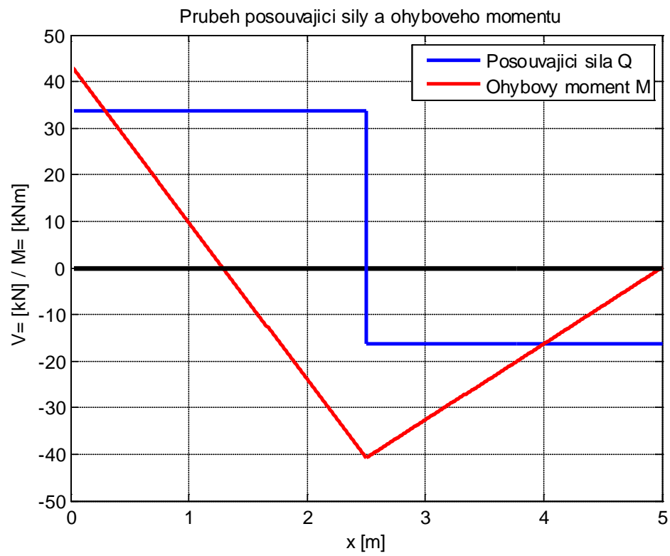
Obr. 9 Průběh posouvající síly a ohybového momentu na nosníku s nedokonalým vetknutím a nedokonalým kloubem
